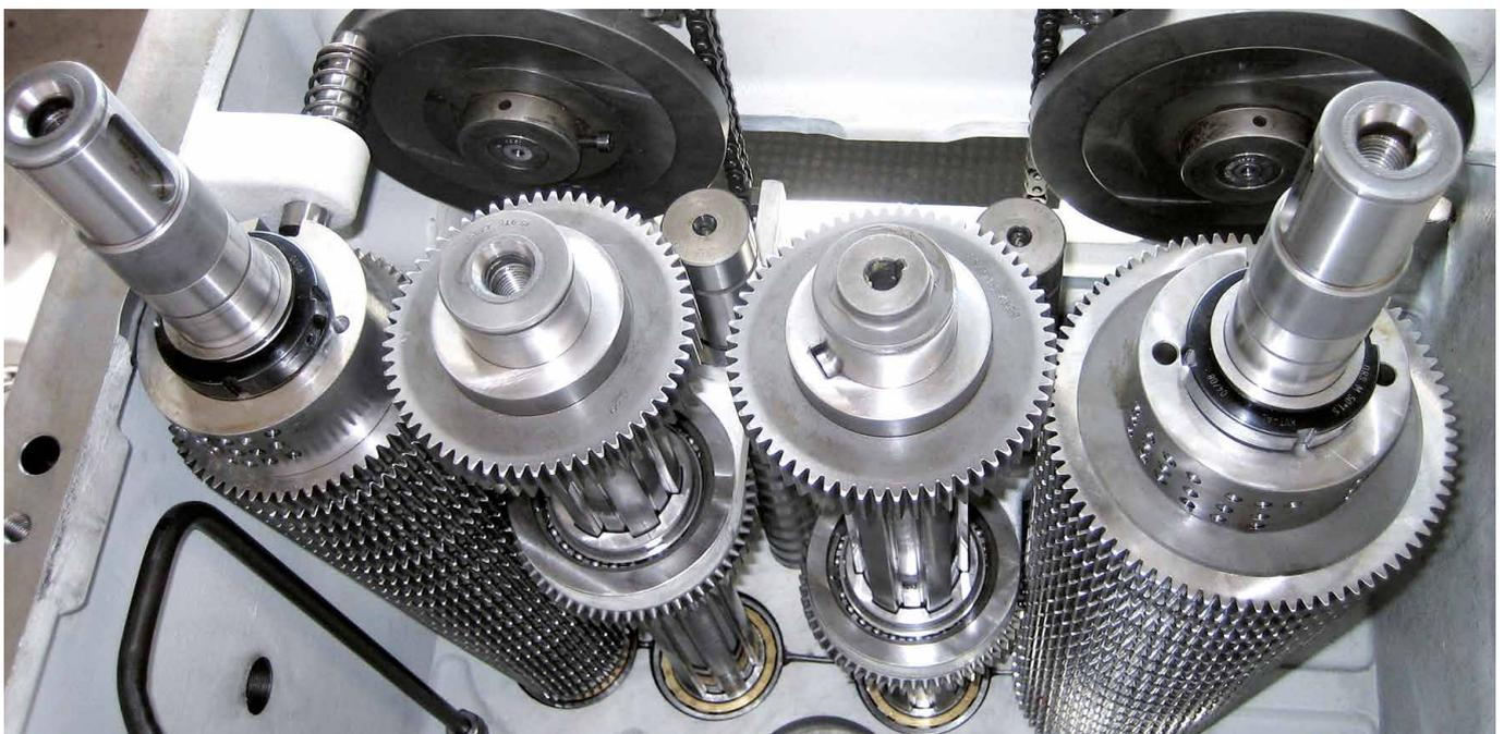
Individuell gefertigtes Schaltgetriebe
